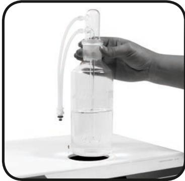
Befüllte Glasflasche vorsichtig in das Gerät einsetzen.
